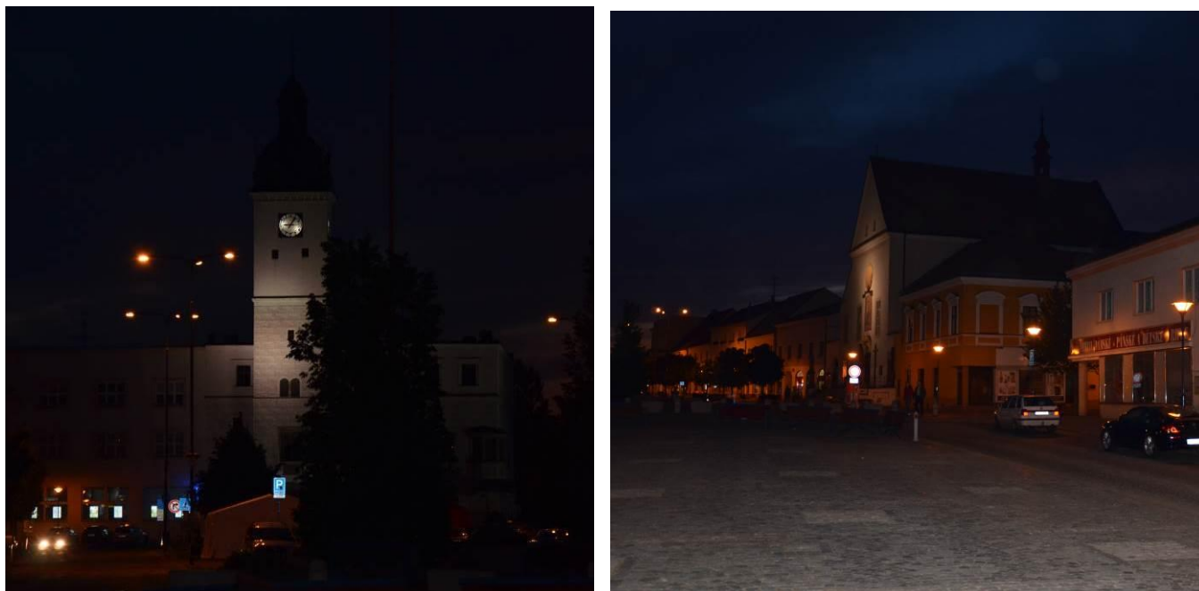
Obrázek 19 Stávající osvětlení radnice a kostela Nanebevzetí P. Marie – radnice osvětlena nerovnoměrně, střecha nemá osvětlení, dominantně osvětleny hodiny, kostel osvětlen pouze z části náměstí, nerovnoměrně
